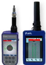
**Inspection connecteur FOCIS Flex et FOCIS Lightning2 (multifibres)**
