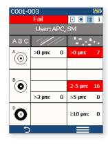
Des résultats de réussite/d'échec en quelques secondes : en une simple pression de bouton, FOCIS Flex effectue une mise au point automatique, capture et centre l'image de l'extrémité, applique les règles de réussite/d'échec, affiche l'image et les résultats de réussite/d'échec. Les résultats de réussite/d'échec peuvent être visualisés facilement dans la vue Image ou Tableau.
