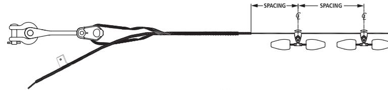
COMPRESSION DEAD END WITH DAMPER ON BARE CABLE
