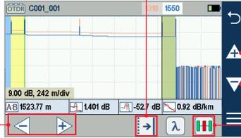
Ampliación en vertical: pulse las flechas arriba/ abajo para ampliar la vista de la trayectoria en vertical en torno al cursor que está activo
